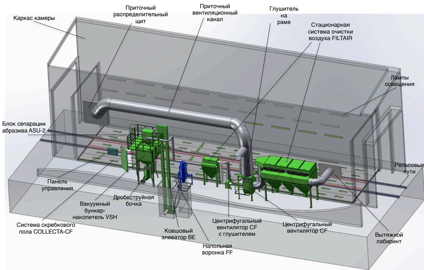
Данная технология подготовки и защиты изделий заключается в дробеструйной обработке поверхности с последующим процессом сбора и регенерации отработанного абразива. На протяжении всего периода производства происходит сохранение определенного климатического состояния окружающей среды.
